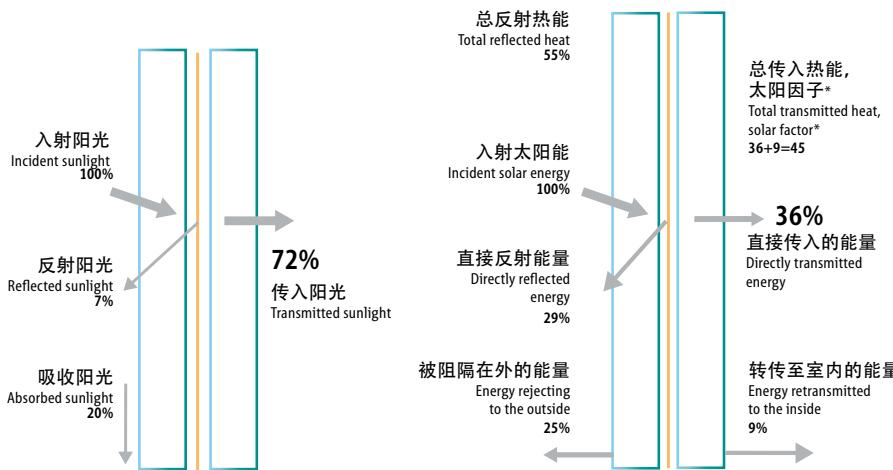
\*太阳能得热系数是给定范围内通过玻璃进入的热量与入射阳光辐射之间的比值, 等于直接传入室内的太阳能加上玻璃吸收后向室内散发的热量。
