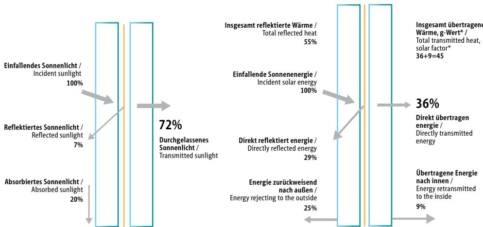
\* Der g-Wert der Verglasung ist das Verhältnis der Wärmemenge, die durch die Verglasung in einen bestimmten Bereich eintritt, zur Intensität der einfallenden Sonnenstrahlung. Sie ist gleich der Summe der Sonnenenergie, die direkt in den Innenraum übertragen wird, plus der Energie, die von der Verglasung als Folge der in dieser Verglasung durch die Energieabsorption aufgebauten Wärme in den Innenraum abgegeben wird
